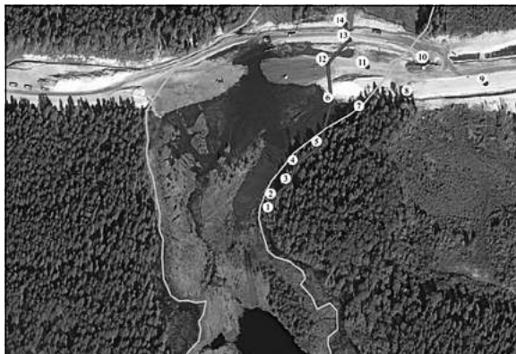
Рис. 3. Схема нивелирного хода
